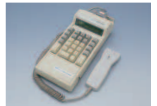
DC2.5 ●エイジスで使用する端末としては初の市販品。 ●ユーザーが使用できるメモリが960KBと大きくPLUマスタの導入が可能となった。 ●AT互換機上で開発したプログラムがそのまま使用できるため、開発したプログラムは今後の資産となる。
