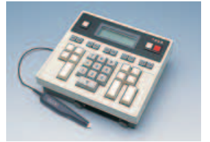
DC-S ●DC-Vに比べて3倍以上のメモリを持ち、軽量化も図られた。 ●名称は、エイジスでつけたDATE COLLECTION SYSTEM & SIXの略。
